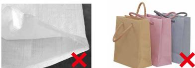
⚠ 货物和辊筒的接触面过小（点接触或线接触），易损坏辊筒（局部磨损，锥套破损等）。
